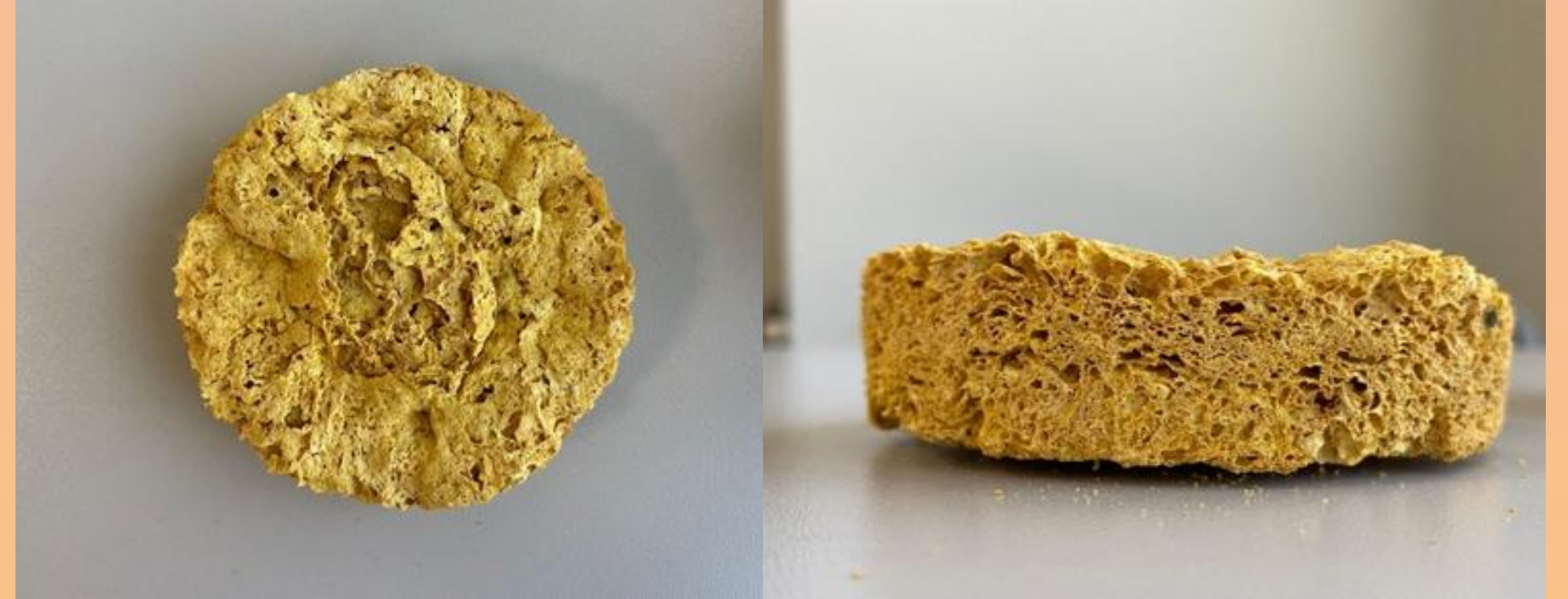
Şekil 5. Elde Edilen Köpüğün Yüzey Morfolojisi
