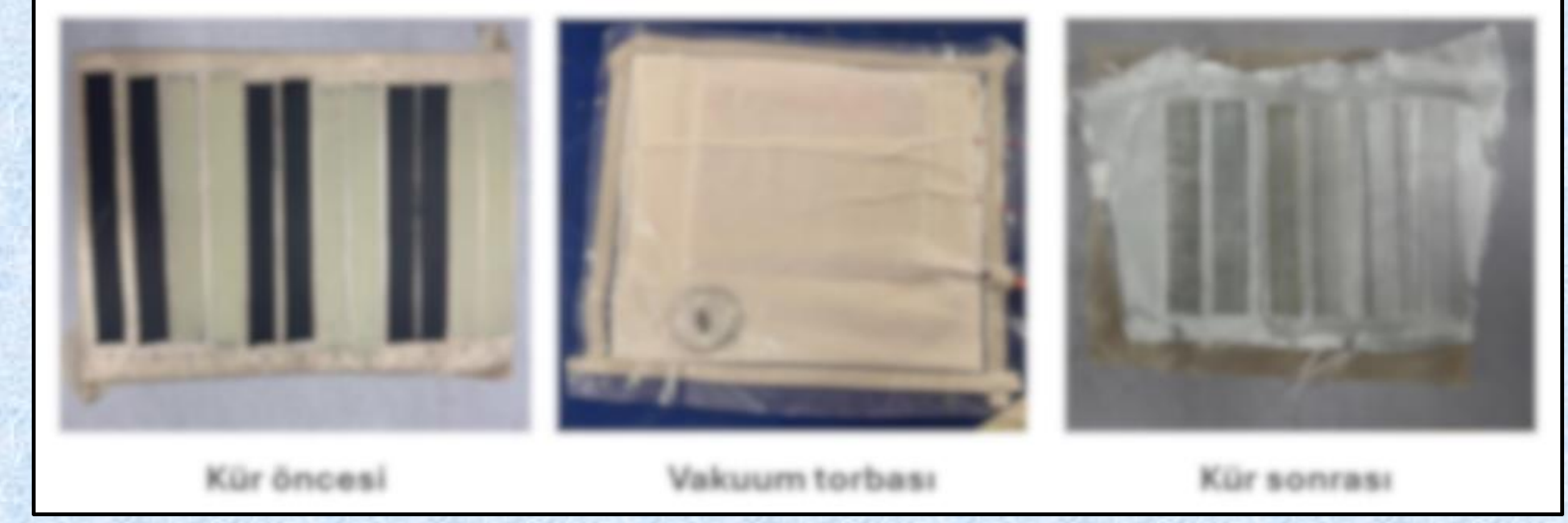
Şekil 5. Lamine kompozitlerin üretim aşaması
