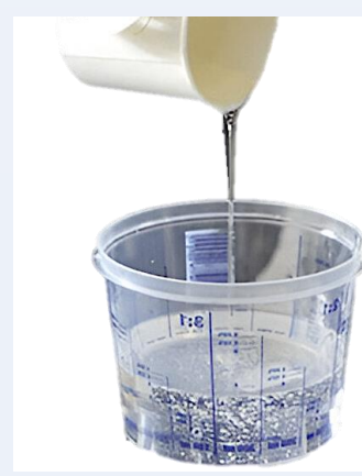
Şekil 2, 3 ve 4. Atık metal tozları, polyester reçine ve sertleştirici
